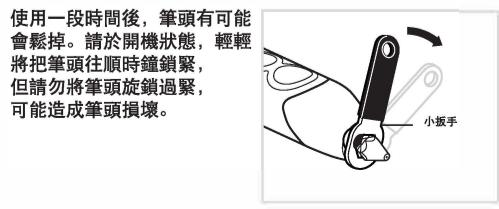
使用一段時間後，筆頭有可能會鬆掉。請於開機狀態，輕輕將把筆頭往順時鐘鎖緊，但請勿將筆頭旋鎖過緊，可能造成筆頭損壞。
